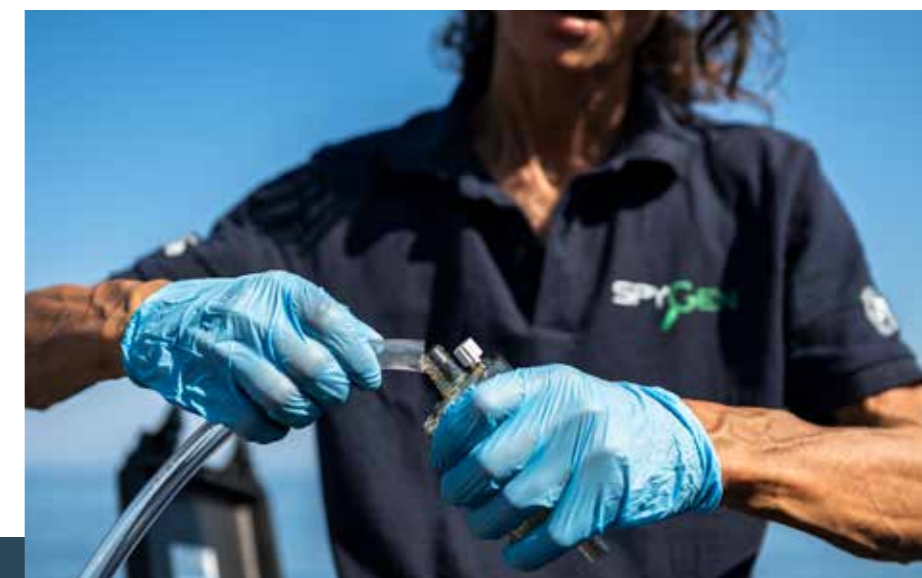
Fixation du tuyau sur la capsule de filtration © Greg Lecoeur, WE ARE MEDITERRANÉE
